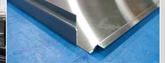
製造2課では切り出した鋼板を曲げる加工を行います。最大長さ6mまで加工することができます。
